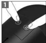
Wenn Sie das System entleeren möchten, drücken Sie gleichzeitig die Espresso- und Lungotaste, um die Maschine auszuschalten.
