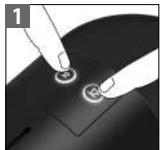
Pro vypnutí přístroje před jeho automatickým vypnutím stiskněte současně tlačítka Espresso a Lungo. Amennyiben az automatikus kikapcsolás előtt szeretné kikapcsolni a készüléket, nyomja meg az Espresso és a Lungo gombokat egyszerre röviden.
