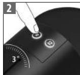
Con la máquina apagada, pulse el botón Espresso durante 3 segundos. El botón Espresso parpadeará indicando el ajuste actual.
