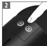
Pro zapnutí přístroje stiskněte tlačítko Espresso nebo Lungo. Tlačítka blikají: nahřívání. Tlačítka svítí: přístroj je připraven k použití.
