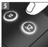
Pendant le chauffage vous pouvez presser le bouton du café désiré lorsqu'il est encore clignotant. Le café coulera alors automatiquement lorsque la machine sera prête.
