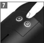
Ανάψτε τη μηχανή πατώντας είτε το κουμπί του Espresso είτε του Lungo. Φώτα που αναβαθμίζονται: Ζέσταμα της μηχανής (25 δευτερόλεπτα). Φώτα αναμμένα σταθερά: Ετοιμη προς χρήση.
