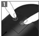
Pro vstup do režimu vypouštění stiskněte současně tlačítka Espresso a Lungo, čímž vypnete přístroj.
