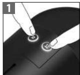
Para apagar la máquina antes de que pase al modo de apagado automático, pulse los botones Espresso y Lungo simultáneamente.
