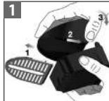
Pour assembler le support de tasse avec le bac d'égouttage: enlevez la grille, placez-les l'un contre l'autre. Clippez le bac d'égouttage dans l'encoche du support de tasse.
