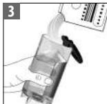
Napолните засобník на воду 0,5 l vody a přidejte odvápnovací tekutinu Nespresso.
