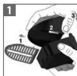
Montage der Tassenauflage und der Abtropfschale: entfernen Sie das Gitter, bringen Sie beide Teile zusammen und lassen Sie die Abtropfschale in die Einkerbung der Tassenauflage einrasten.
