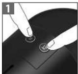
Wyłączyć ekspres wciskając jednocześnie przyciski Espresso i Lungo.
