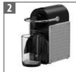
Retire el depósito de agua. Baje la palanca. Coloque un recipiente bajo la salida del café. Remova o depósito de água. Coloque um recipiente debaixo da saída de café.
