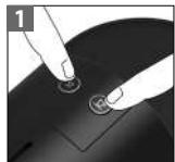
Για να μπείτε σε λειτουργία αδειάσματος, πατήστε και τα δύο κουμπιά Espresso και Lungo για να σβήσετε τη μηχανή.
