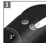
Um den Energiesparmodus zu verlassen, halten Sie die Lungotaste für 3 Sekunden gedrückt.
