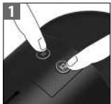
Para entrar en el modo de vaciado, pulse los botones Espresso y Lungo simultáneamente para apagar la máquina.
